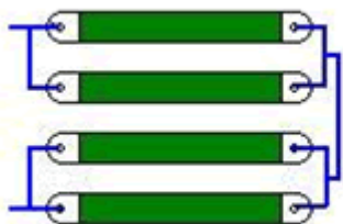
图 1-4 外接制动电阻的安装方式
